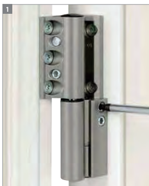
1. W celu dokonania regulacji bocznej należy odblokować śrubę kontrującą.
