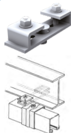
sposób montażu prowadnicy do elementu konstrukcyjnego budynku
